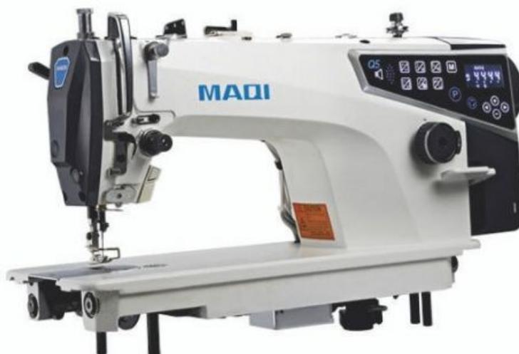
1-игольная компьютеризированная машина челночного стежка с микростежком перед обрезкой нитки и голосовым супроводом нажатия кнопок
