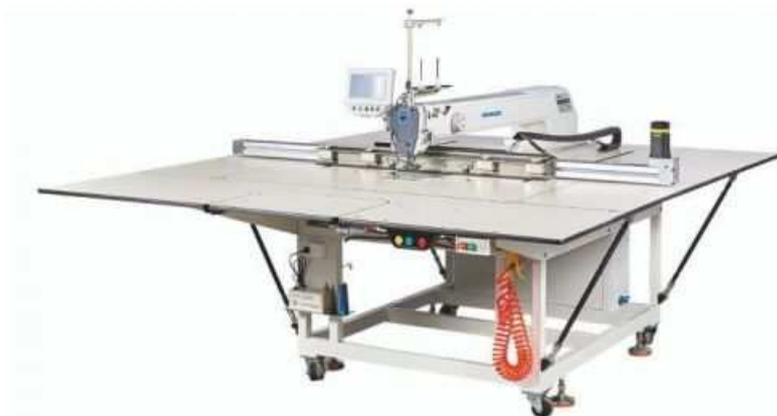
Программированная машина циклического шитья, рабочее поле машины 1300 x 850 мм
