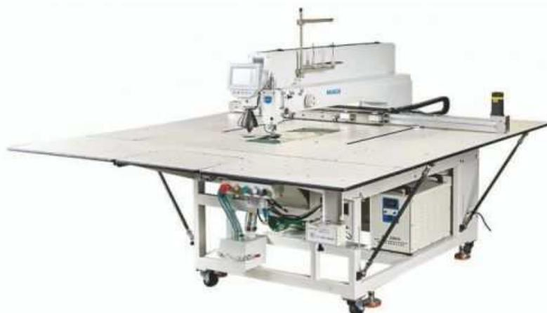
Программируемая машина циклического шитья с лазером. Рабочее поле машины 1300 x 840 мм
