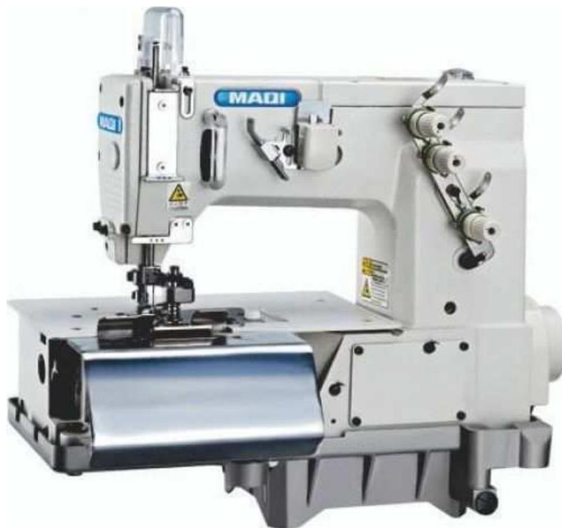
Шлёвочная машина с двухсторонней подрезкой края материала
