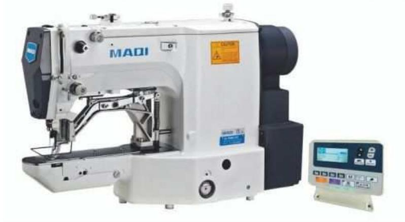
Электронная закрепочная машина с рабочем полем 30x40 мм для тяжёлых материалов
