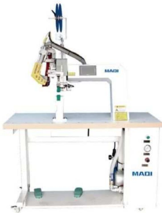
промышленная машина для герметизации швов (проклейка)
